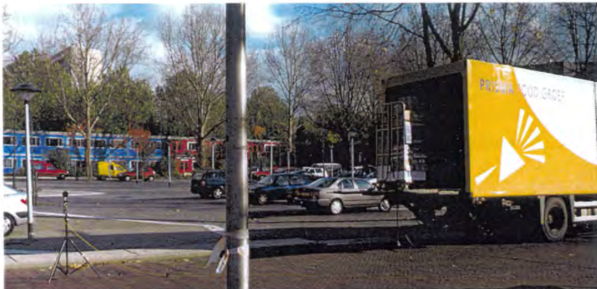
Figuur 5: Rolgeluidmetingen op een KVS laag op een Dautel laadklep
