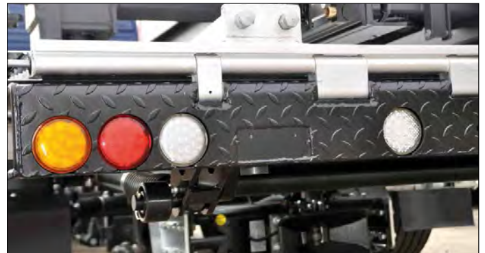
LED-Schlussleuchten, Kennzeichenhalter und Beleuchtung
