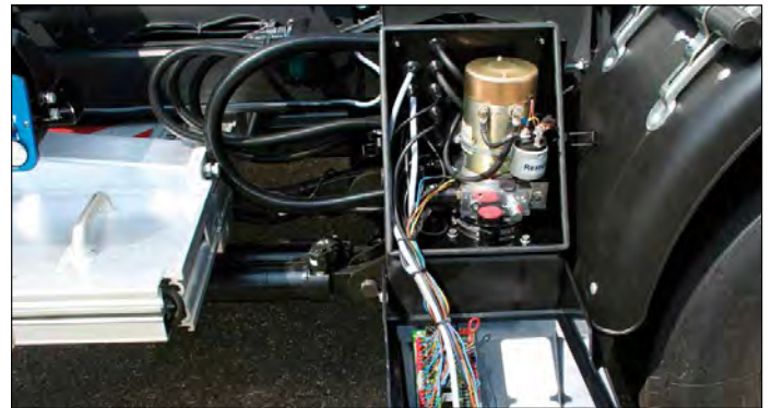
Servicefreundliches Antriebsaggregat mit klappbarem Deckel
