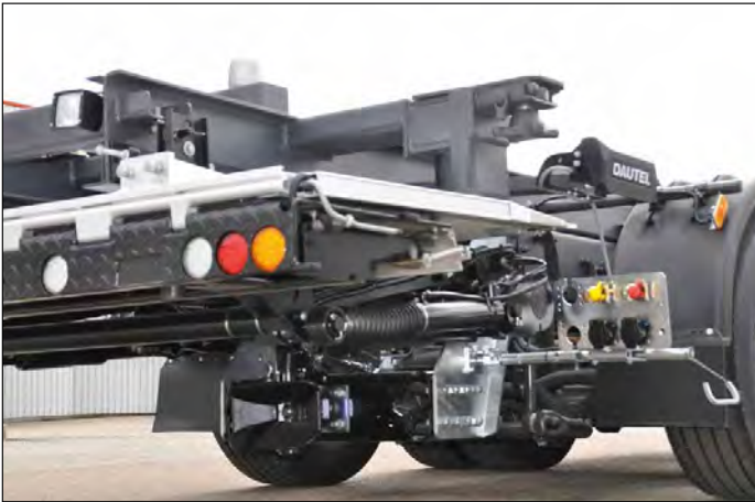
DAUTEL SLIDER DS-VT, mit BDF-Wechselaufbau Abstellhöhe 1120 + 1320 mm
