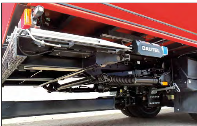
DAUTEL SLIDER DS-VT mit Kofferaufbau
